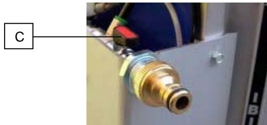
– Чтобы отключить устройство и продолжить работу без воды, просто перекройте кран.
